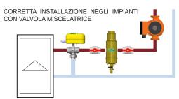
il combifar orientabile è adatto all'installazione su tubazioni con disposizione verticale ed orizzontale in quanto la parte con gli attacchi filettati può ruotare di 360° attorno al proprio asse.
