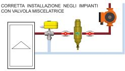
il combifar orientabile è adatto all'installazione su tubazioni con disposizione verticale ed orizzontale in quanto la parte con gli attacchi filettati può ruotare di 360° attorno al proprio asse.
