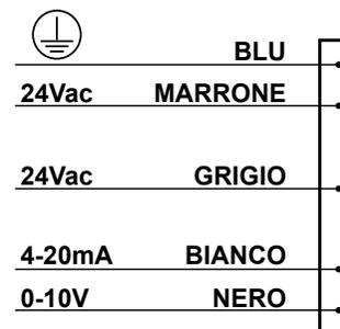
Per comandare l'apertura e la chiusura della valvola di zona per mezzo del servocomando, basta collegare il cavo di colore blu al neutro, il cavo di colore marrone alla fase ed il cavo di colore nero alla centralina di comando 0-10V (oppure il cavo bianco se la regolazione è 4-20mA). Il cavo di colore grigio serve invece per invertire il punto di partenza del motore, si consiglia, per le nostre applicazioni, di lasciarlo sempre sotto tensione.
